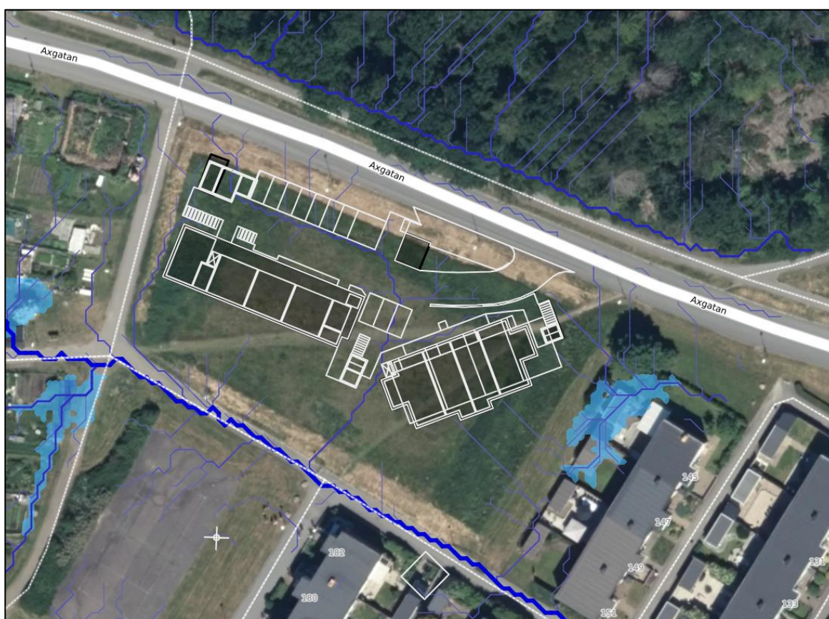
Figur 26. Rinnvägar (blå linjer) och lågpunkter (ljusblå områden) vid framtida förhållanden. Planerad exploatering symboliseras av vita linjer. Marknivån vid planerat LSS-boende och flerbostadshus har justerats efter tilltänkt höjdsättning. Tillkommande byggnader och stödmur har höjts (svartmarkerade områden). Markanvändningen har justerats. Ingen annan modifikation av höjdmodellen har gjorts (SCALGO, 2023).
