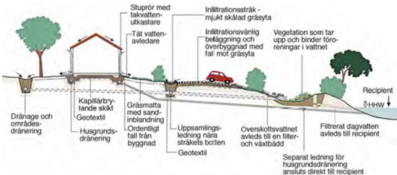
Öppen avledning av dagvatten (P105 Svenskt Vatten)
