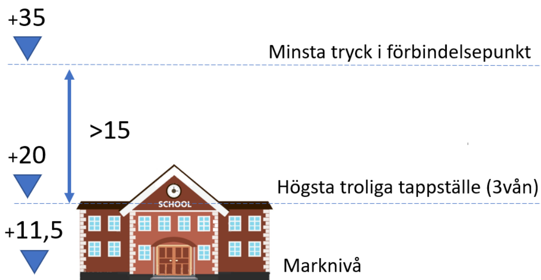
Figur 42 Princip erforderligt tryck i förbindelsepunkt
