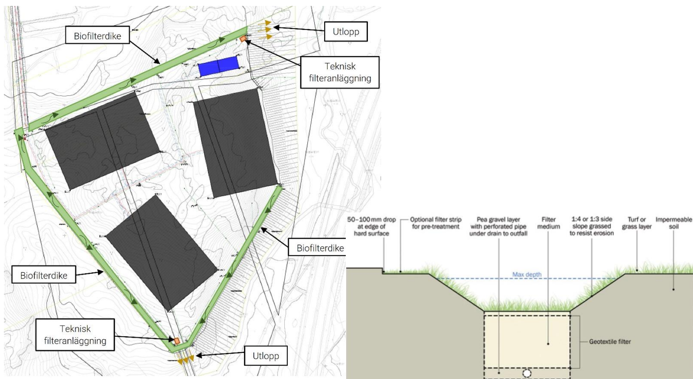
Figur 11.4. Principskiss för biofilterdike och schematisk karta över planområdet med denna lösning (AFRY 2023).
