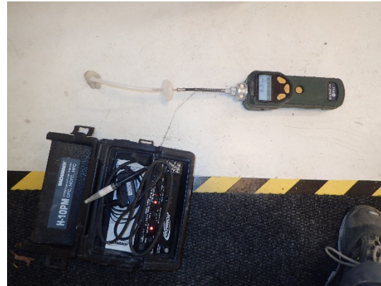
Figur 17. Porgasen under byggnaderna har mätts med både PID och HDI.
