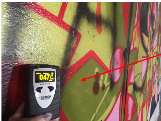
Figur 22. Gammamätningar på plan 4 i by 18 visar att den utgörs av blåbetong.
