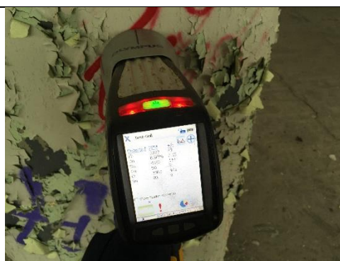
Figur 10. Prov 10. Samlingsprov färgflagor by 18. Höga halter av tungmetaller.
