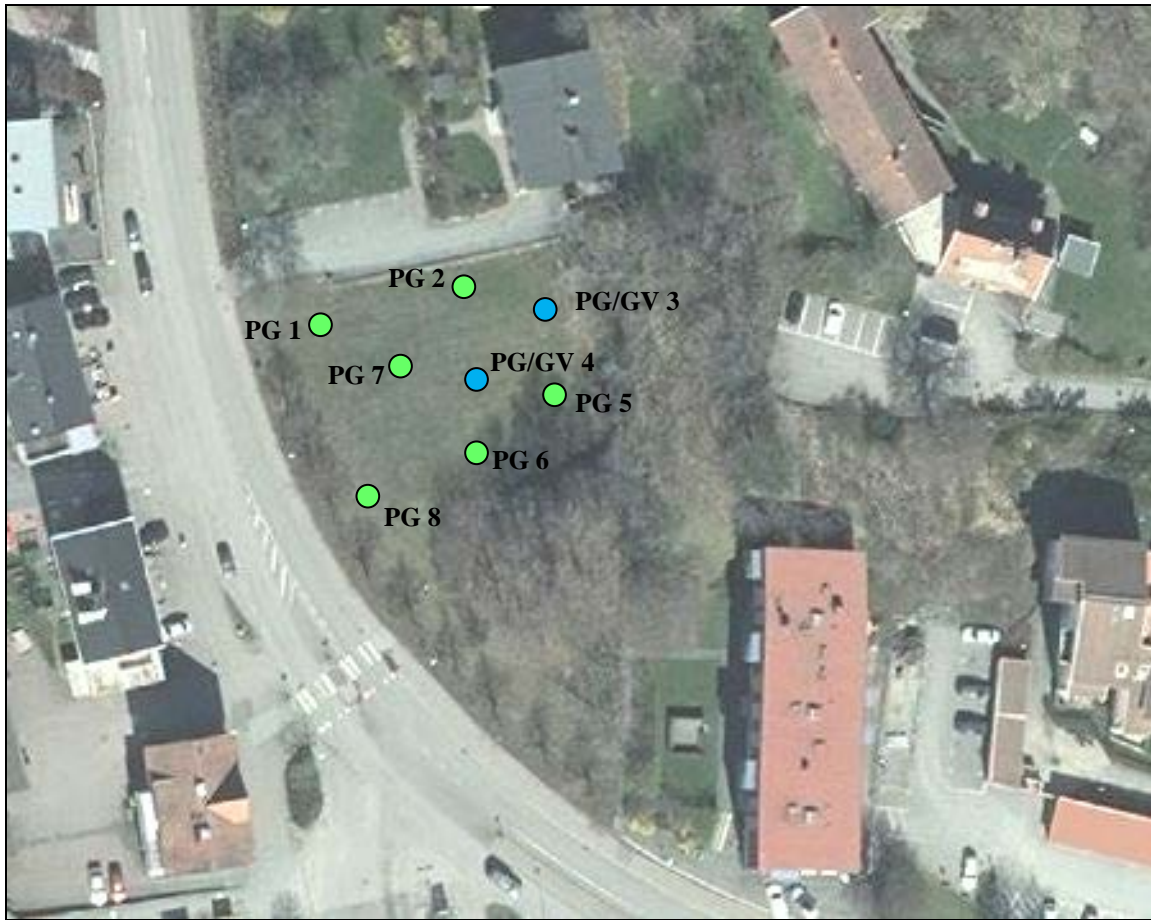
Figur 7. Lokalisering av provpunkter vid f.d. bussgarage.
