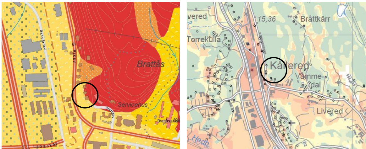
Figur 6. Till vänster en geologisk karta visande att området till stor del består av glacial finlera. Till höger en jorddjupskarta som visar att jorddjupen i regel är betydande och överstiger 5 m.
