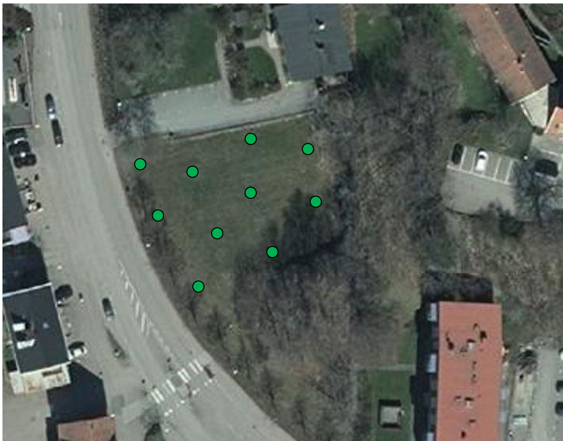
Figur 7. Förslag till jordprovtagning i sammanlagt 10 punkter på fastigheten Våmmedal 3:15.
