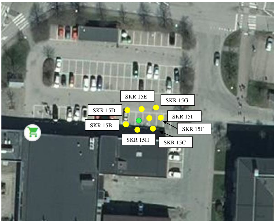
Figur 8. Kompletterande skruvborrning på parkeringsplatsen kring SKR 15. Grön markering avser SKR 15. Gula markeringar avser kompletterande provpunkter.
