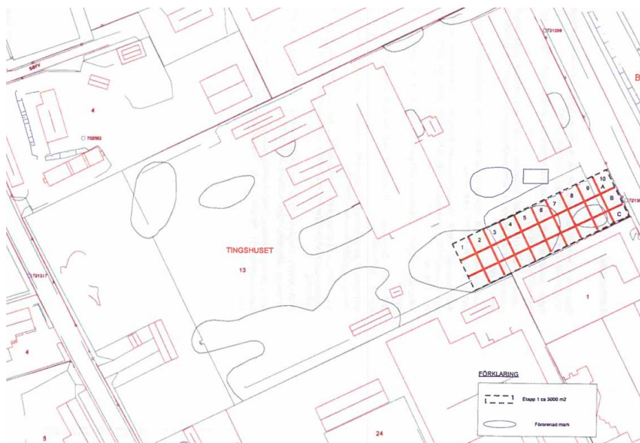
Figur 5. Visar bedömd utbredning av förorenad mark inför sanering samt läget av det delområde som åtgärdades inom ramen för "etapp 1" (röda rutor). Det sanerade delområdet återfylldes med bergkross. Källa: WSP 2008.
