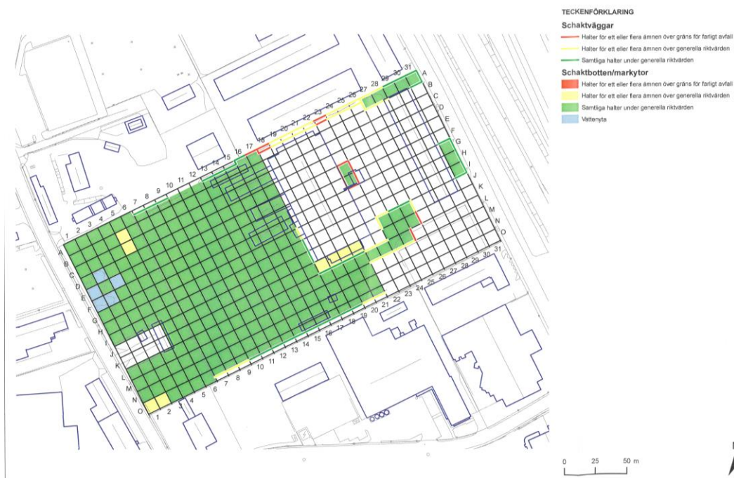
Figur 7. Figuren visar klassning av schaktbotten (grönt = samtliga halter under generella riktvärden (mätbara åtgärds mål, MKM)) samt information om var förhöjda halter konstaterats i schaktväggar (röda och gula markeringar). Källa: Golder 2009 (bilaga 3 till slutrapporten för etapp 2).
