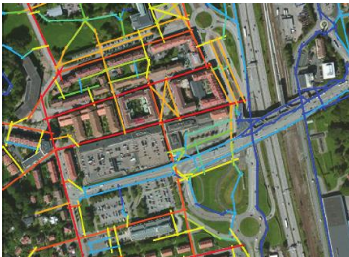
Figur 3.5. Utsnitt av illustration av stråkanalys för Mölndals innerstad samt Forsåkersområdet. Rött indikerar hög grad av rumslig integration, blått indikerar låg grad.
