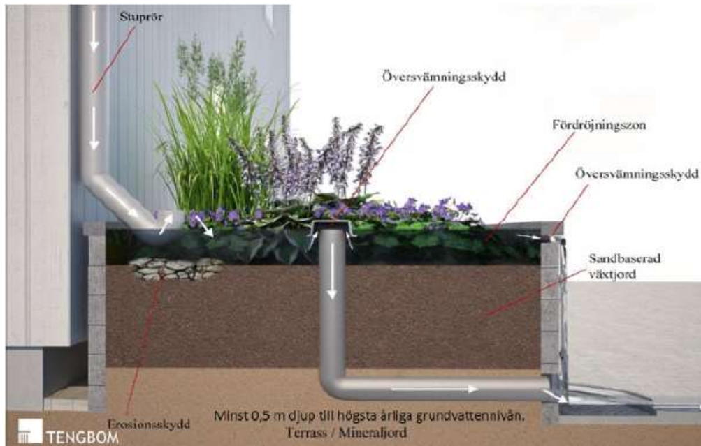
Figur 7. En växtbädd med fördröjnings- och översvämningsskydd för infiltrering och behandling av dagvatten. (Tengbom arkitektkontor, 2014)
