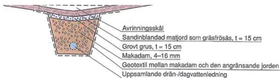
Figur 19. Dräneringsstråk utan dagvattenintag. (Svenskt Vatten P105, 2011)
